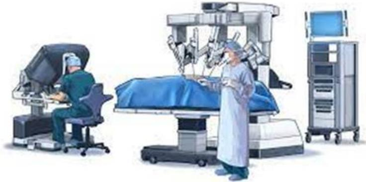
«*da Vinci Surgical System*» состоит из двух блоков – для хирурга оператора и четырёхрукого робота манипулятора (исполнительного устройства). Одна из «рук» держит видеокамеру, две другие в режиме реального времени воспроизводят движения хирурга, четвертая выполняет функции ассистента. Врач хирург управляет с пульта с использованием специальных джойстиков и следит за ходом операции на мониторе в 3D изображении с увеличением.
